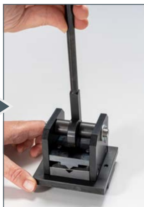
Werkstück formen mit der Biegepresse aus TZ 200.01
