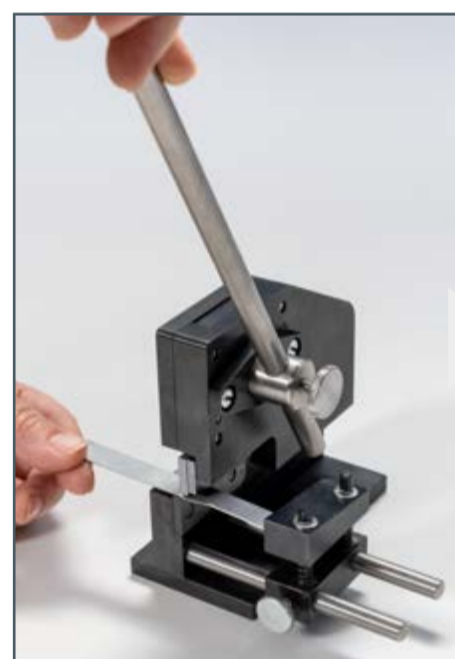
Blech schneiden mit der Hebelschere aus TZ 200.07
