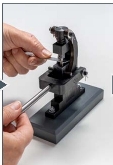
Löcher stanzen mit der Hebelpresse aus TZ 300
