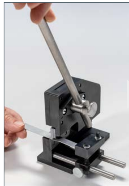
Découpage de la tôle avec la cisaille à levier TZ 200.07
