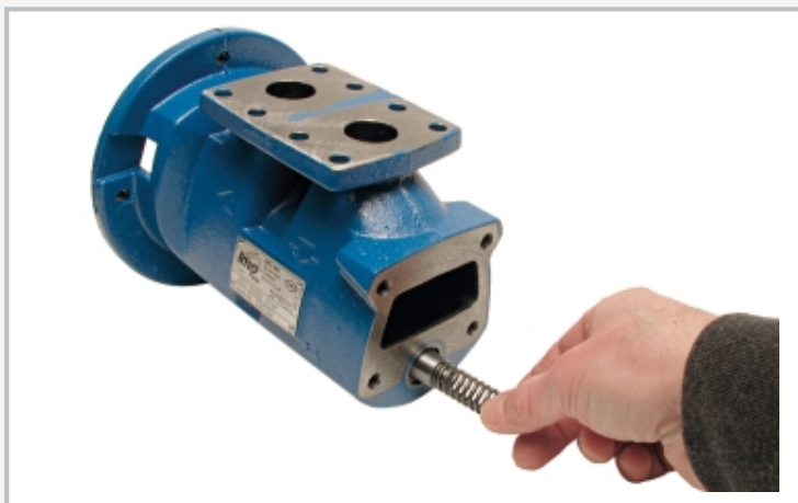
Montage de la pompe à vis: monter le piston à soupape avec ressort de soupape
