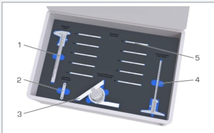
1 pied à coulisse, 2 jauge de rayon, 3 goniomètre universel, 4 pied à coulisse de profondeur, 5 objet de contrôle (pièce angulaire)
