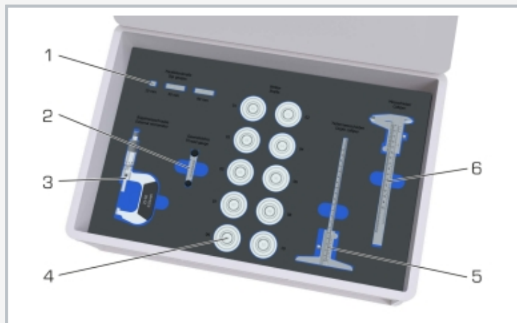
1 cale étalon, 2 calibre de filetage, 3 micromètre extérieur, 4 objet de contrôle (arbre), 5 pied à coulisse de profondeur, 6 pied à coulisse
