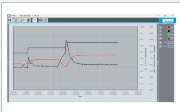
Capture d'écran du logiciel: régulation de pression avec un régulateur P continu, échelons de grandeur de référence et écart de réglage permanent à la grandeur réglée
