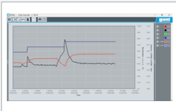
Screenshot der Software: Druckregelung mit kontinuierlichem P-Regler, Führungsgrößen-sprünge und bleibende Regelabweichung bei der Regelgröße
