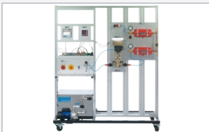
L'illustration montre le montage d'une régulation de pression. En plus du module de base RT 450, les composants suivants sont utilisés: RT 450.03 (module système réglé, pression), RT 450.10 (régulateur), RT 450.12 (enregistreur), RT 450.20 (vanne de régulation) et RT 450.30 (capteur de pression).
