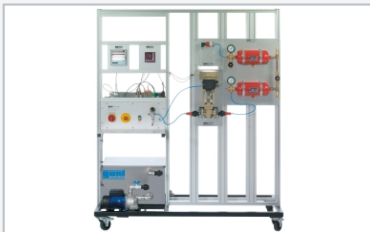
La ilustración muestra la estructura de una regulación de presión. Además del módulo base RT 450 están incluidos los siguientes componentes: RT 450.03 (módulo del sistema controlado: presión), RT 450.10 (regulador), RT 450.12 (registrador), RT 450.20 (válvula de control) y RT 450.30 (sensor de presión).
