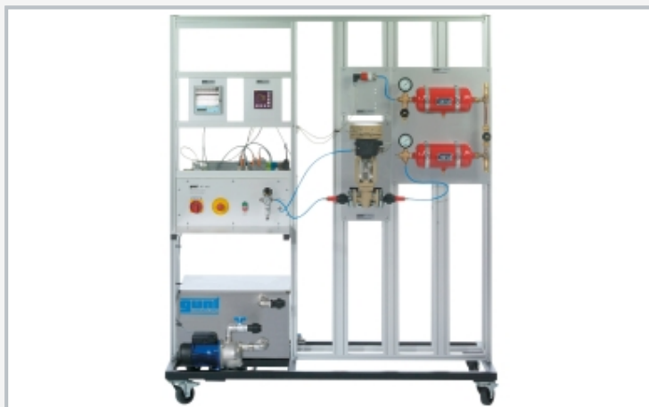
Die Abbildung zeigt den Aufbau einer Druckregelung. Neben dem Grundmodul RT 450 sind folgende Komponenten enthalten: RT 450.03 (Regelstreckenmodul Druck), RT 450.10 (Regler), RT 450.12 (Schreiber), RT 450.20 (Regelventil) und RT 450.30 (Druckaufnehmer).
