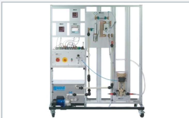
L'illustration montre le montage d'une régulation de température. En plus du module de base RT 450, les composants suivants sont utilisés: RT 450.04 (module système réglé, température), RT 450.11 (régulateur), RT 450.12 (enregistreur), RT 450.21 (vanne de régulation) et RT 450.36 (capteur de température).
