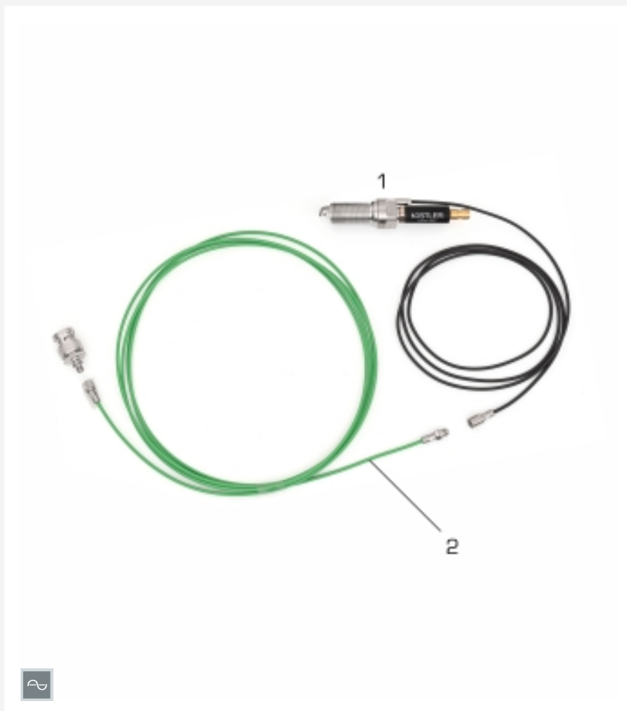
1 bougie avec capteur de pression, 2 câble de connexion
