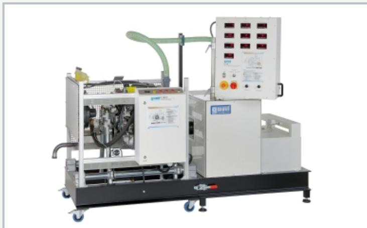
L'illustration montre le CT 400 avec le moteur diesel CT 400.02.
