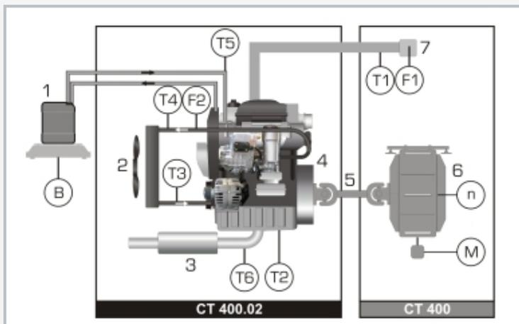
1 réservoir d'essence, 2 radiateur, 3 échappement, 4 moteur, 5 arbre de transmission, 6 frein à courants de Foucault, 7 entrée d'air; n vitesse de rotation, M couple, B consommation d'essence, débit volumétrique: F1 air, F2 eau de refroidissement, températures: T1 air d'aspiration, T2 huile, T3 entrée d'eau de refroidissement, T4 sortie d'eau de refroidissement, T5 essence, T6 gaz d'échappement
