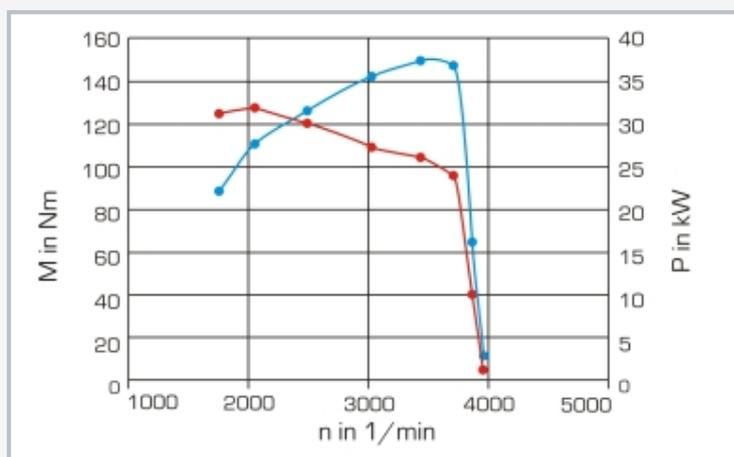
Caractéristiques de couple et de puissance du moteur:
