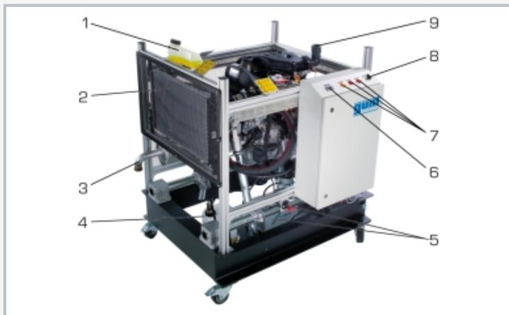
1 réservoir d'eau de refroidissement, 2 radiateur avec grille de protection, 3 raccord des gaz d'échappement, 4 réservoir de carburant, 5 batterie avec interrupteur principal de batterie, 6 compteur d'heures de service, 7 témoins d'avertissement, 8 interrupteur à clé pour l'allumage, 9 raccord pour l'admission d'air du moteur
