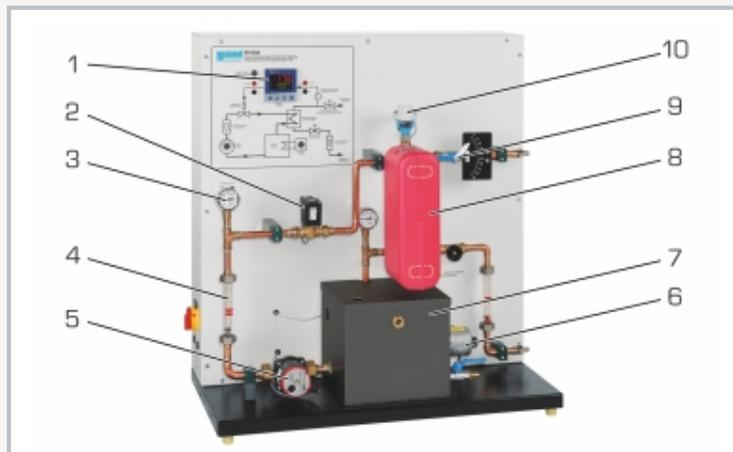
1 régulateur, 2 vanne de régulation, 3 thermomètre, 4 rotamètre, 5 pompe, 6 chauffage avec thermostat, 7 réservoir, 8 échangeur de chaleur à plaques, 9 robinet à tournant sphérique avec échelle, 10 capteur de température à la sortie d'eau fraîche
