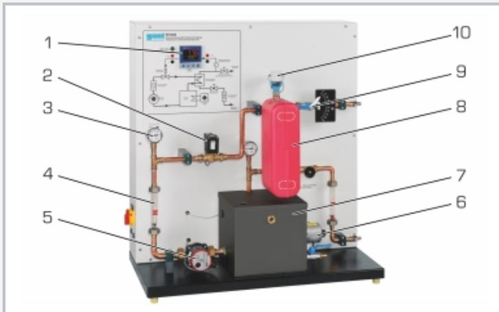
1 Regler, 2 Regelventil, 3 Thermometer, 4 Schwebekörper-Durchflussmesser, 5 Pumpe, 6 Heizer mit Thermostat, 7 Behälter, 8 Plattenwärmeübertrager, 9 Kugelhahn mit Skala, 10 Temperaturenfnehmer am Frischwasseraustritt
