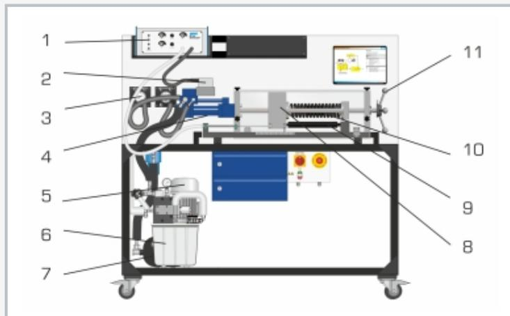
1 amplificateur de régulation, 2 soupape de régulation, 3 manomètre de pression de cylindre, 4 vérin hydraulique, 5 pompe, 6 réservoir d'huile, 7 accumulateur hydraulique, 8 chariot, 9 amortisseur, 10 ressorts, 11 molette de réglage du ressort
