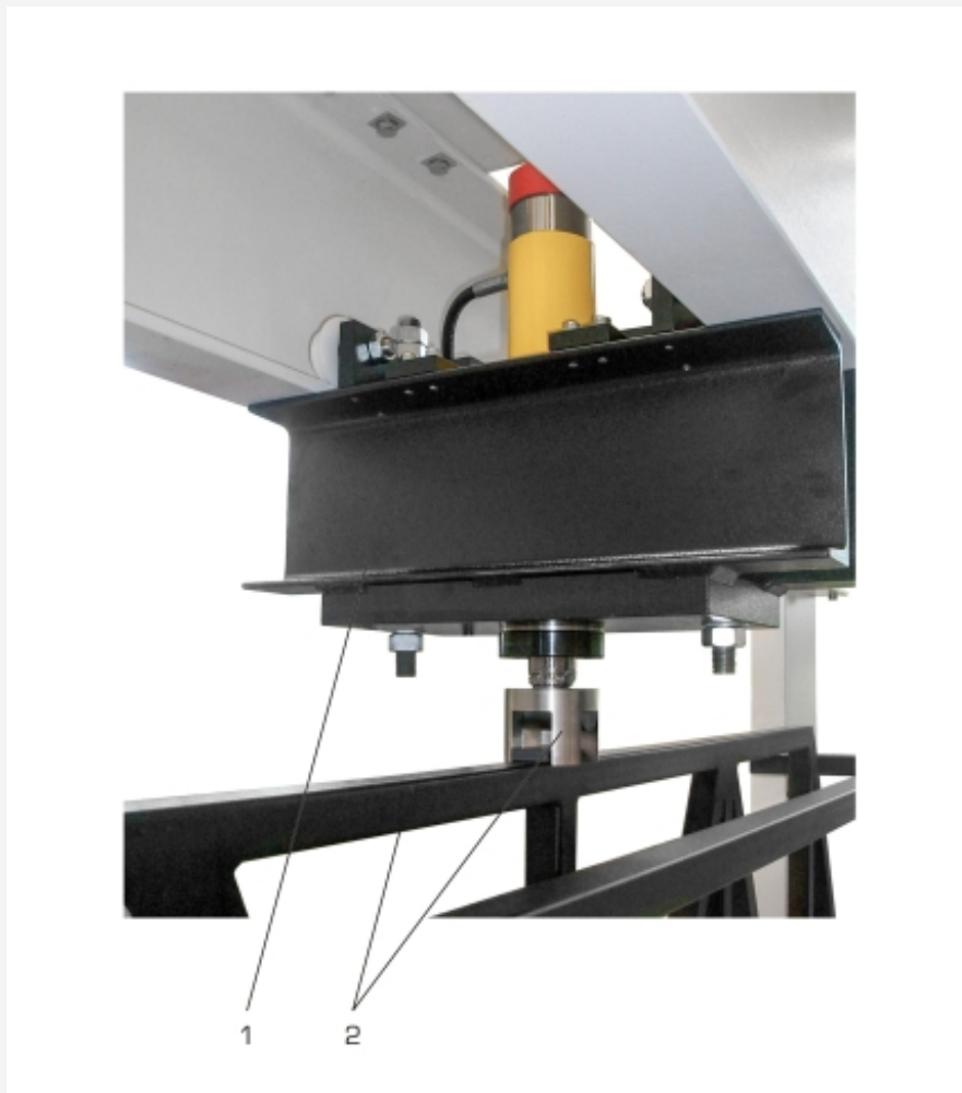
1 Belastungsvorrichtung mit Pressenzylinder, 2 Fachwerk mit Belastungsschuh SE 100.04
