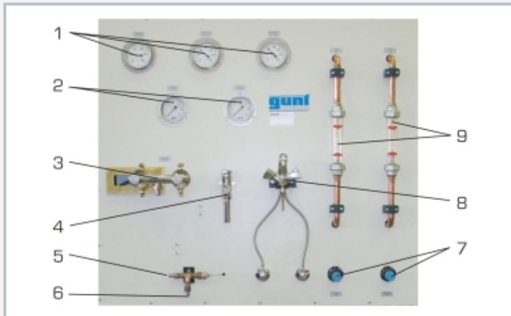
1 thermomètre, 2 manomètres à tube de Bourdon, 3 robinet mélangeur mural, 4 robinet de chasse d'eau, 5 entrée d'eau mélangée, 6 évacuation d'eau mélangée, 7 soupape de réduction de pression, 8 robinet mélangeur sur pied, 9 rotamètre
