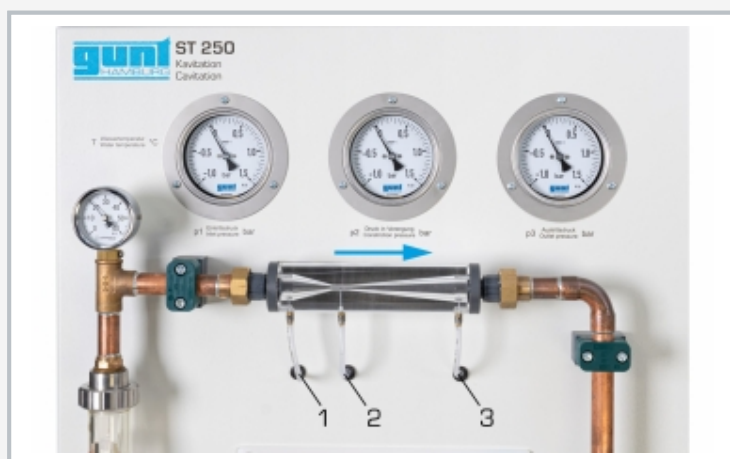
Mesure de la pression par un tube de Venturi avec 3 points de mesure et manomètres: p_1 pression à l'entrée, p_2 pression sur la section la plus étroite, p_3 pression à la sortie; flèche bleue: direction du courant
