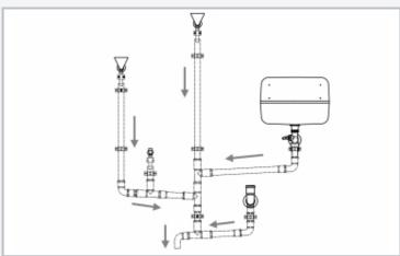
Le système des eaux usées à l'arrière rassemble et évacue les eaux usées provenant du rinçage à contre-courant, de groupe de sécurité, de purge d'air dans les tuyaux et de l'évier.
