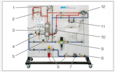
1 purge d'air, 2 soupape de sécurité thermique, 3 réservoir à pression avec le chauffage, 4 groupe de sécurité, 5 soupape de réduction de pression, 6 filtre de rinçage à contre-courant avec soupape de réduction de pression, 7 compteur d'eau, 8 alimentation en eau, 9 séparateur, 10 pompe, 11 mitigeur bicommande, 12 mitigeur monocommande
