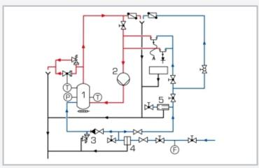
Schéma de processus: 1 réservoir à pression avec le chauffage, 2 pompe, 3 groupe de sécurité, 4 filtre de rinçage à contre-courant avec soupape de réduction de pression, 5 séparateur
