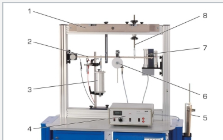
1 alojamiento de péndulo, 2 oscilador de viga, 3 depósito del amortiguador de aceite, 4 equipo de mando para excitador de desequilibrio, 5 bandeja para otros péndulos, 6 excitador de desequilibrio, 7 registrador de tambor, 8 muelle
