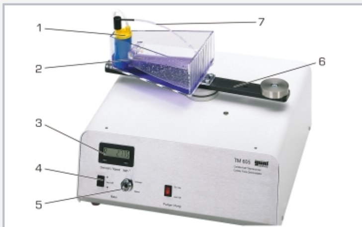
1 pompe, 2 réservoir d'eau, 3 affichage de la vitesse de rotation, 4 commutateur de modification du sens de rotation, 5 ajustage de la vitesse de rotation, 6 bras rotatif, 7 jet d'eau
