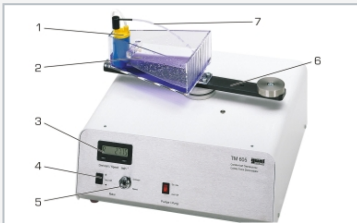
1 bomba, 2 depósito de agua, 3 indicación del número de revoluciones, 4 conmutador para la dirección de rotación, 5 ajuste de número de revoluciones, 6 brazo giratorio, 7 chorro de agua
