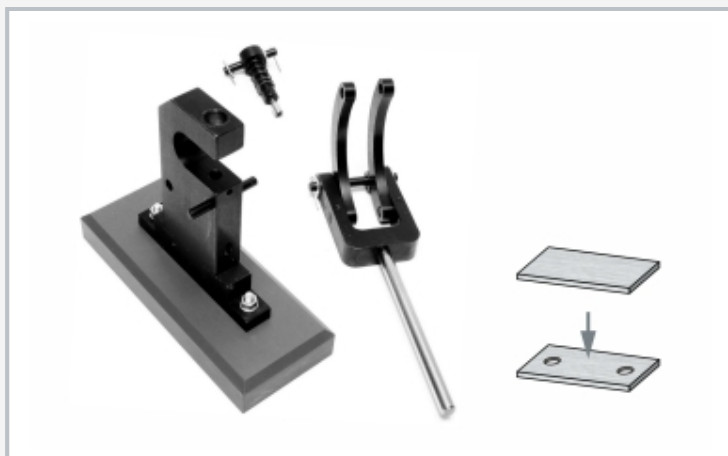
Hebelpresse zerlegt in Funktionsgruppen: Gabel, Druckbolzen, Grundkörper, rechts das Produkt der Hebelpresse
