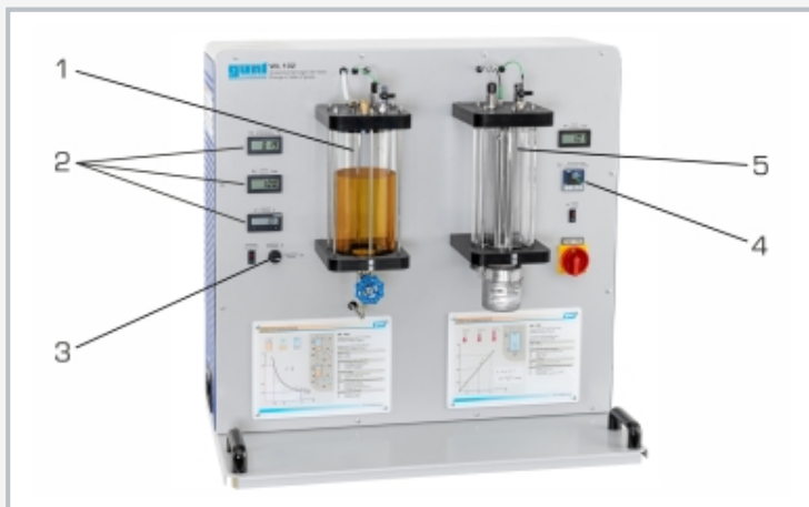
1 Behälter 1 für isotherme Zustandsänderung, 2 digitale Anzeigen, 3 Umschalten zwischen Verdichten/Expandieren mit einem 5/2-Wege-Ventil, 4 Heizungsregler, 5 Behälter 2 für isochore Zustandsänderung
