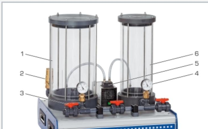
1 réservoir en surpression, 2 soupape de sécurité, 3 robinet à tournant sphérique, 4 manomètre, 5 compresseur, 6 réservoir en dépression
