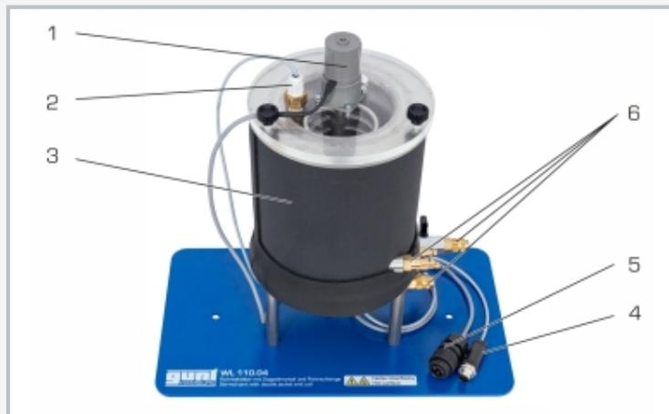
1 motor del mecanismo de agitación, 2 sensor de temperatura, 3 depósito de agitación, 4 conexión de sensor de temperatura, 5 conexión del motor del mecanismo de agitación, 6 empalme de agua de la camisa, del/ al depósito de agitación, del serpentín
