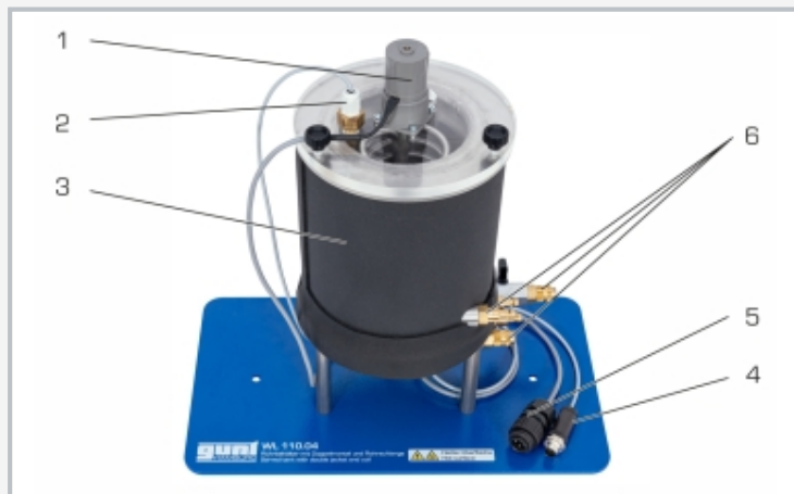
1 Rührwerk-Motor, 2 Temperatureaufnehmer, 3 Rührbehälter, 4 Anschluss Temperatureaufnehmer, 5 Anschluss Rührwerk-Motor, 6 Wasseranschlüsse Mantel, Rührbehälter, Rohrschlange
