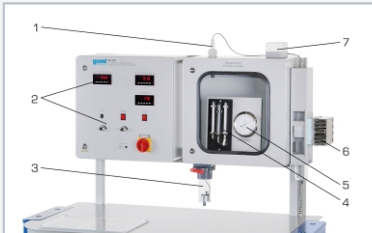
1 kapazitiver Feuchteaufnehmer, 2 Anzeige- und Bedienelemente, 3 Befeuchter, 4 Psychrometer, 5 Haar-Hygrometer, 6 Entfeuchter, 7 Hygrometer mit synthetischen Fasern und kombiniertem Temperaturenfnehmer
