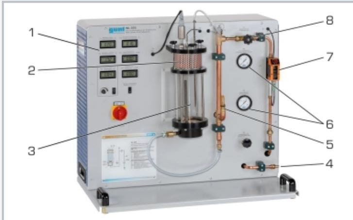
1 panneau d'affichage et de commande, 2 filtre à air, 3 réacteur en verre rétro-éclairé, 4 raccord d'air comprimé, 5 soupape de sécurité, 6 manomètre, 7 débitmètre, 8 soupape d'ajustage du débit d'air
