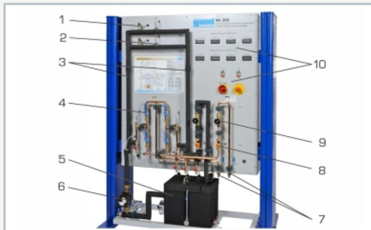
1 soupape de purge, 2 capteur de température, 3 échangeurs de chaleur, 4 robinet à tournant sphérique avec ajustage du mode de fonctionnement, 5 réservoir avec dispositif de chauffage, 6 pompe, 7 raccords d'eau, 8 débitmètre, 9 soupape d'ajustage du débit, 10 éléments d'affichage et de commande
