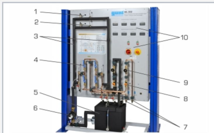
1 Entlüftungsventil, 2 Temperaturnahme, 3 Wärmeübertrager, 4 Kugelhahn zur Einstellung der Betriebsart, 5 Behälter mit Heizer, 6 Pumpe, 7 Wasseranschlüsse, 8 Durchflussmesser, 9 Ventil zur Einstellung des Durchflusses, 10 Anzeige- und Bedienelemente
