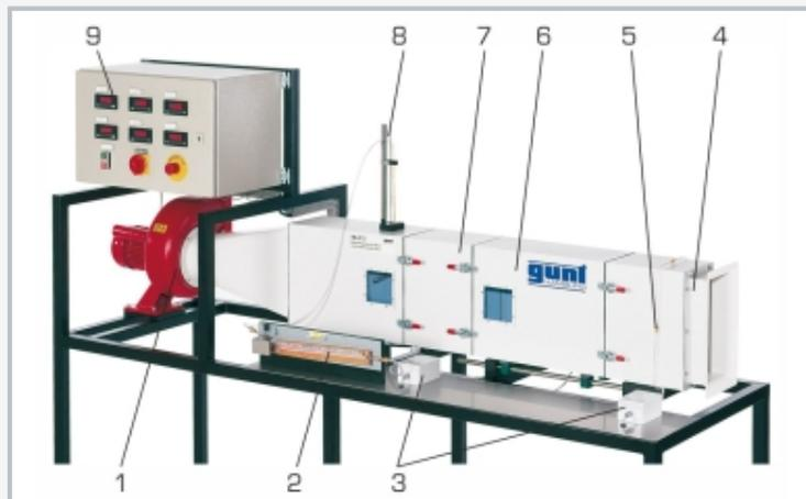
1 soplante con válvula de mariposa, 2 manómetro de tubo inclinado, 3 sensor de presión diferencial, 4 entrada que favorece a la corriente, 5 medición de presión vía tobera de medida, 6 conducto de aire con ventanas, 7 sección de medición para accesorios intercambiables, 8 tubo de Pitot, 9 elementos de indicación y mando
