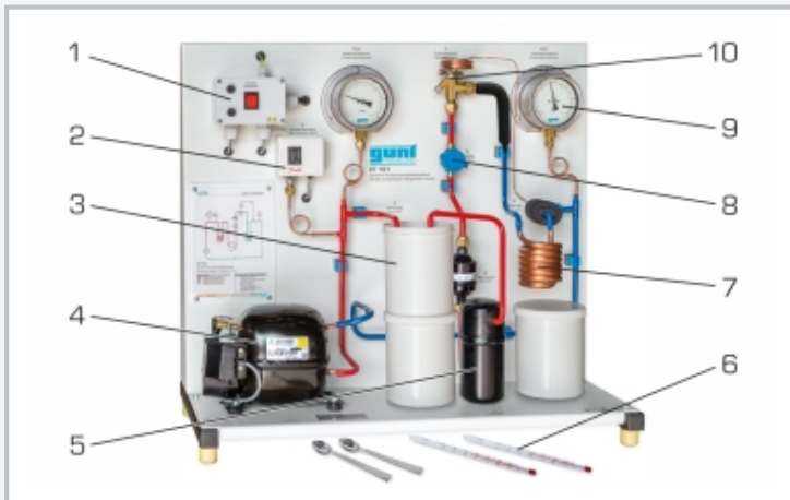
1 Hauptschalter, 2 Druckschalter, 3 Verflüssiger mit Wasserbehälter, 4 Verdichter, 5 Sammler, 6 Thermometer, 7 Verdampfer, 8 Schauglas (Kältemittel), 9 Manometer, 10 Expansionsventil
