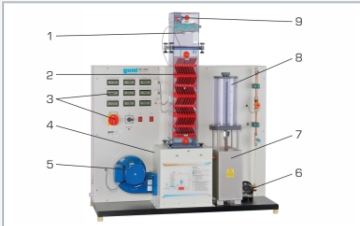
1 Düse als Zerstäuber, 2 Rieseleinbauten, 3 Anzeige- und Bedienelemente, 4 Luftkammer, 5 Gebläse mit Drosselklappe, 6 Pumpe, 7 Wasserbehälter mit Heizung, 8 Behälter für Zusatzwasser, 9 kombinierter Temperatur-/Feuchteaufnehmer
