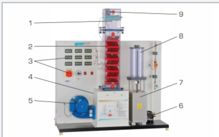
1 buse comme pulvérisateur, 2 surface de ruissellement, 3 éléments d'affichage et de commande, 4 chambre à air, 5 ventilateur avec vanne papillon, 6 pompe, 7 réservoir avec dispositif de chauffage, 8 réservoir d'eau supplémentaire, 9 capteur combiné de température et d'humidité
