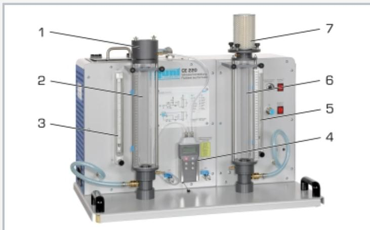
1 alimentation en eau, 2 réservoir d'eau, 3 rotamètre pour l'eau, 4 appareil de mesure portable pour la perte de charge, 5 rotamètre pour l'air, 6 réservoir pour l'air, 7 filtre
