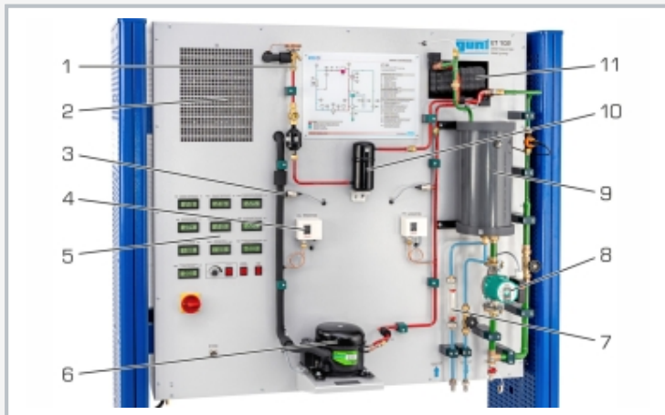
1 válvula de expansión, 2 evaporador con ventilador; 3 sensor de presión, 4 presostato, 5 elementos de indicación y mando, 6 compresor, 7 caudalímetro agua de refrigeración, 8 bomba, 9 depósito de agua caliente, 10 recipiente, 11 condensador
