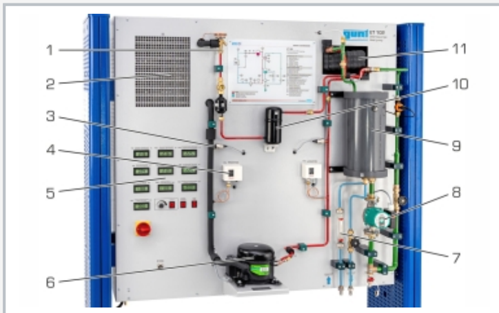
1 Expansionsventil, 2 Verdampfer mit Ventilator, 3 Druckaufnehmer, 4 Druckschalter, 5 Anzeige- und Bedienelemente, 6 Verdichter, 7 Durchflussmesser Kühlwasser, 8 Pumpe, 9 Warmwasserbehälter, 10 Sammler, 11 Verflüssiger
