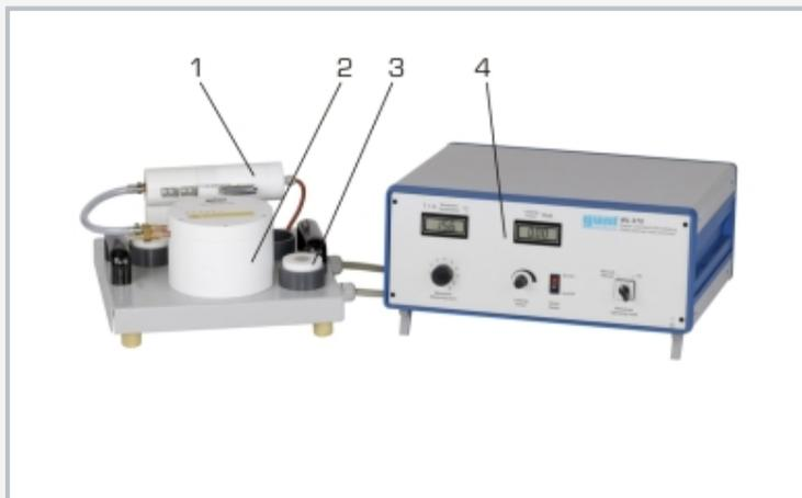
1 Versuchsaufbau zur linearen Wärmeleitung, 2 Versuchsaufbau zur radialen Wärmeleitung, 3 Messobjekt, 4 Anzeige- und Bediengerät
