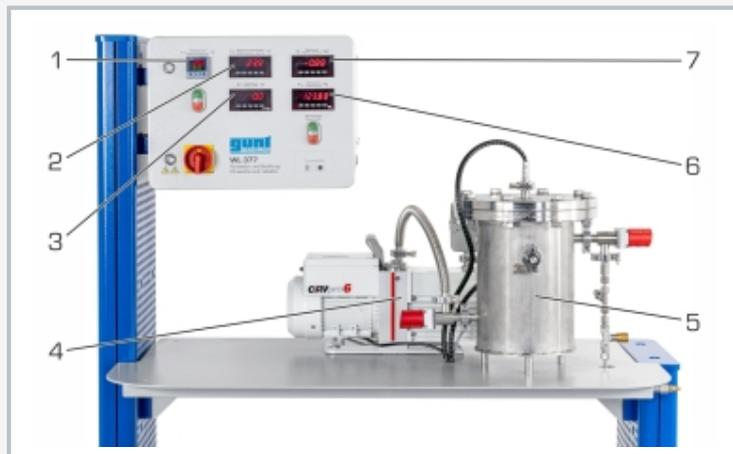
1 regulador de temperatura con indicador de temperatura, 2 indicador de temperatura, 3 indicador de potencia, 4 bomba de vacío, 5 depósito a presión, 6 indicador de presión (presión abs. en el depósito), 7 indicador de presión (presión rel. en el depósito)
