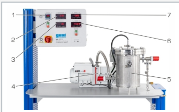
1 régulateur de température avec affichage de température, 2 affichage de température, 3 affichage de puissance, 4 pompe à vide, 5 réservoir sous pression, 6 affichage de pression (pression absolue dans le réservoir), 7 affichage de pression (pression relative dans le réservoir)
