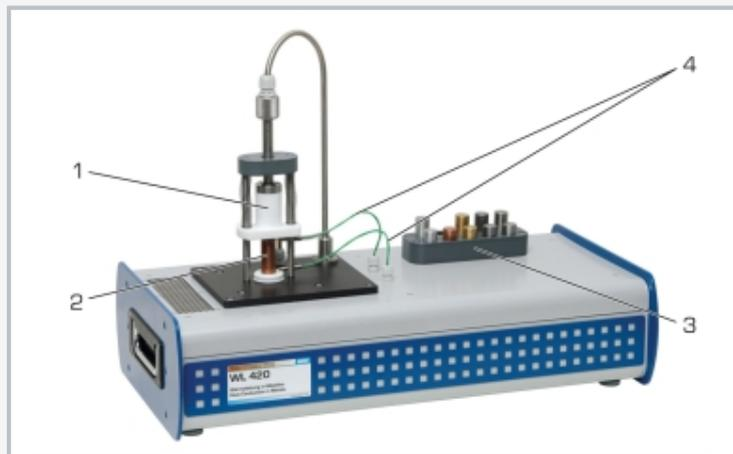
1 dispositif de chauffage, 2 éprouvette, 3 rangement pour éprouvettes, 4 thermocouple; élément Peltier caché
