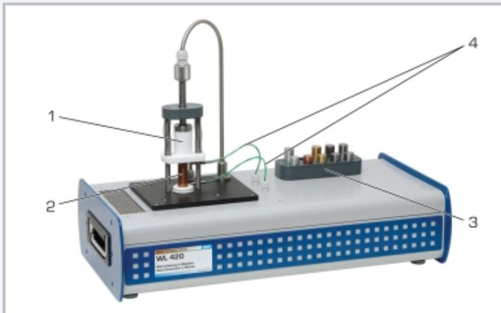
1 Heizer, 2 Probe, 3 Ablage für Proben, 4 Thermoelement; Peltierelement verborgen
