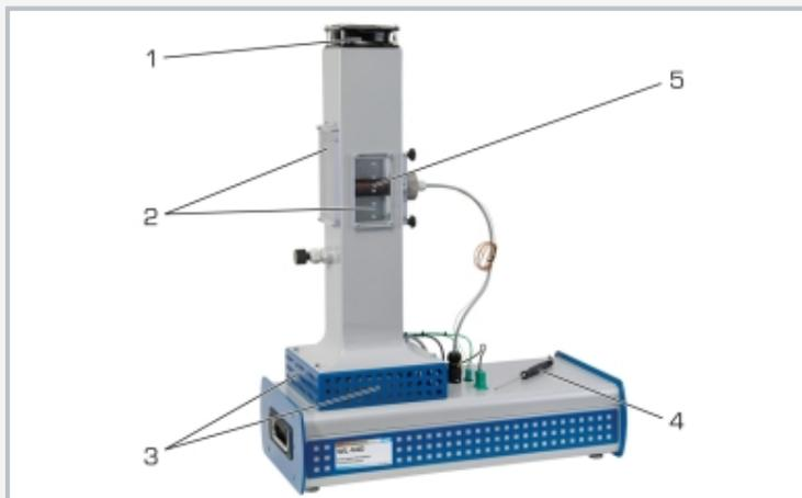
1 soufflante, 2 voyant, 3 entrée d'air, 4 instrument portatif de mesure de température, 5 élément de chauffage
