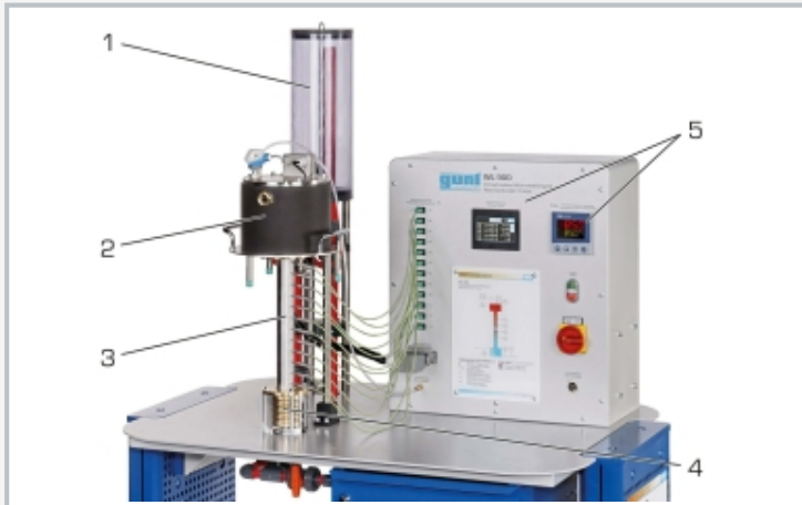
1 Hochbehälter für konstanten Kühlwasservordruck, 2 Wärmequelle mit Heizer, 3 Probe, 4 wassergekühlte Wärmesenke, 5 Anzeige- und Bedienelemente
