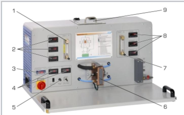
1 Durchflussmesser Kaltwasser, 2 Temperaturanzeigen kalte Seite, 3 Temperaturregler Wasserbehälter, 4 Spannungs- und Stromanzeige, 5 Einstellung der elektrischen Leistung, 6 Peltierelement mit Wärmeübertragern, 7 Durchflussmesser Warmwasser, 8 Temperaturanzeigen warme Seite, 9 Abdeckung Wasserbehälter
