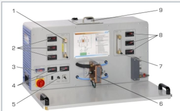
1 débitmètre d'eau froide, 2 affichages de température du côté froid, 3 régulateur de température du réservoir d'eau, 4 affichages de tension et courant, 5 ajustage de la puissance électrique, 6 élément Peltier avec des échangeurs de chaleur, 7 débitmètre d'eau chaude, 8 affichages de température du côté chaud, 9 couvercle de réservoir d'eau
