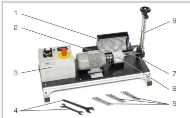
1 capot de protection, 2 moteur électrique, 3 coffret de commande, 4 outil, 5 éprouvettes, 6 palier, 7 éprouvette maintenue, 8 dispositif de charge avec balance à ressort et roue à main
